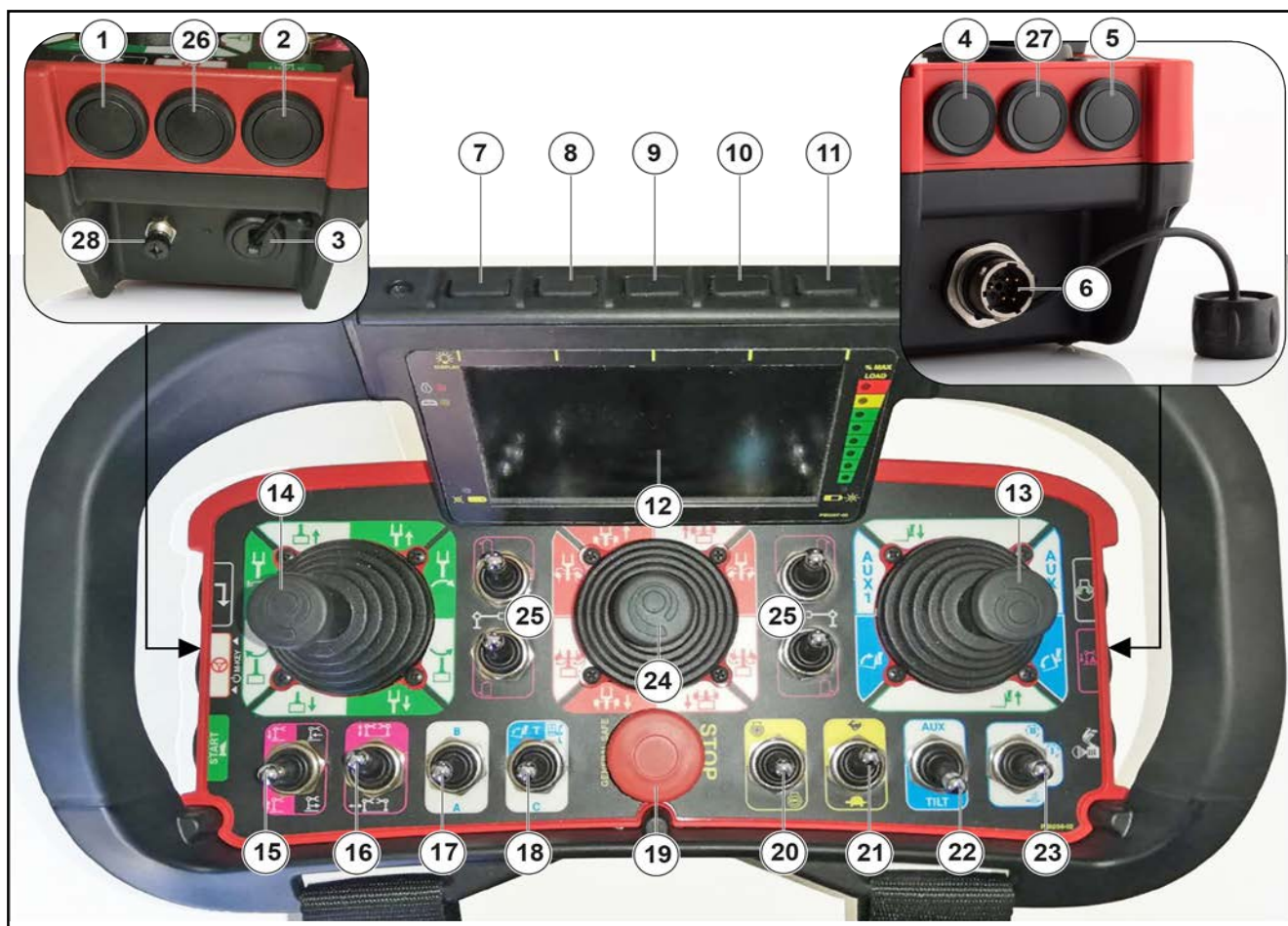
Figure 119: Panneau de commande à boutons-poussoirs de l'émetteur
