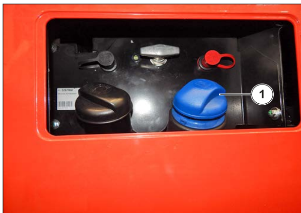
Figure 122: Remplissage du réservoir de DEF
